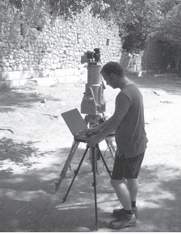
Res. 1 Üç boyutlu lazer tarayıcı kullanılarak yapılan çalışmalar Fig. 1 Working with 3-D laser scanner
